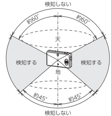
本機内蔵の傾斜センサーの検知範囲は、上図の通りです。倒れている場合でも、「検知しない」範囲では検知しません。検知範囲を十分にご理解のうえご使用ください。また、必ず動作テストを行い、検知範囲をご確認ください。
